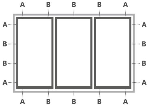
**Overkarm og sidekarm:** Hullene kan bli boret i både det innvendige og utvendige spor, **men ikke bor hull i den termiske isolasjonen (svart plastikkdel):**
