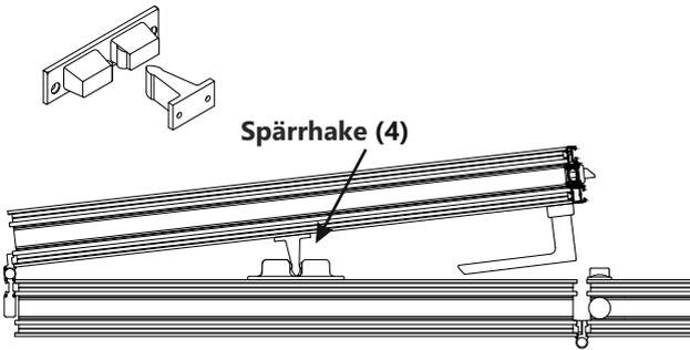
Vid användning måste panelen med åtkomst dörr ledas på nästa panel så att spärrhaken kan tryckas fast, innan återstående paneler kan vikas.
