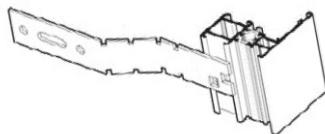
2. Kläm fast metallfästen som visas på bilden; 150 mm från hörnen (A) och lika avstånd på max. 800 mm (B) runt ramens sidor och ovsida.
